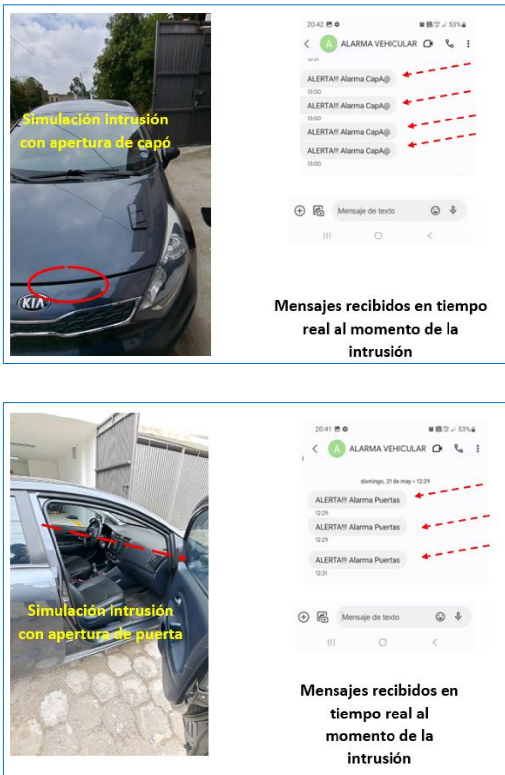
Figura 37. Detalle de las pruebas de intrusión en el capó y puertas. Fuente: Los autores.
