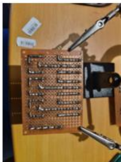
Parte posterior tarjeta de interruptores eléctricos
