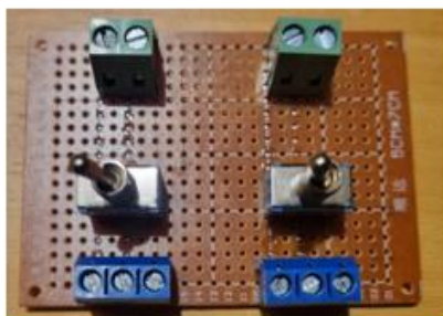
Tarjeta de interruptores eléctricos
