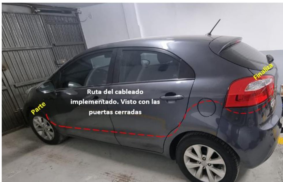
Figura 33. Muestra de la ruta para la implementación del cableado. Fuente: Los autores.
