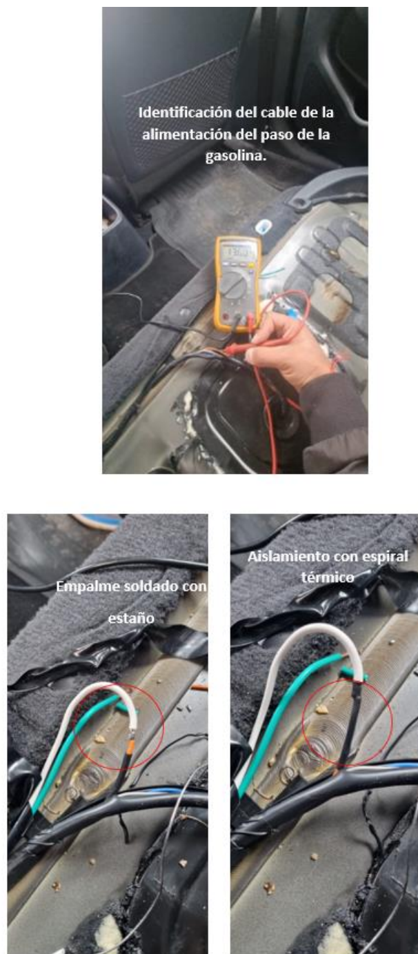
Figura 35. Identificación del cable para el corte del paso de la gasolina, soldadura y aislamiento. Fuente: Los autores.
