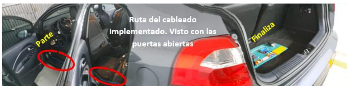
Figura 34. Implementación del cableado. Fuente: Los autores.
