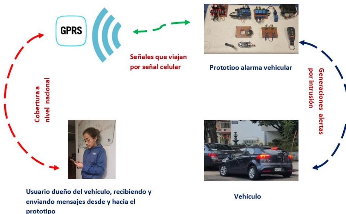
Figura 22. Ilustración de la bidireccionalidad para el envío de eventos mediante SMS. Fuente: Los autores.
