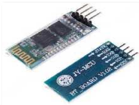
Figura 10. Módulo HC-06. Fuente: [8].
