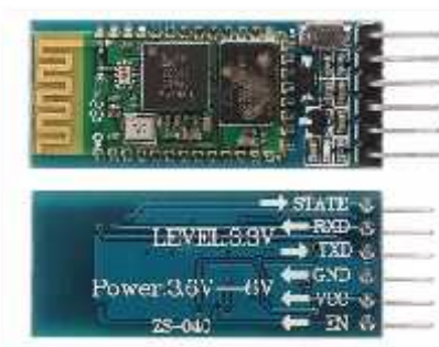
Figura 11. Módulo HC-05. Fuente: [10].
