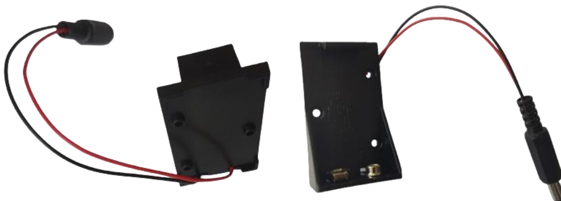
Figura 41. Soporte con adaptador de batería de 9 voltios con salida de plug universal de 5.5 mm y 2.1 mm. Fuente: El Autor.
