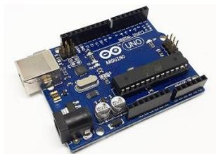
**Figura 4. Placa Microcontrolador Arduino UNO.**
