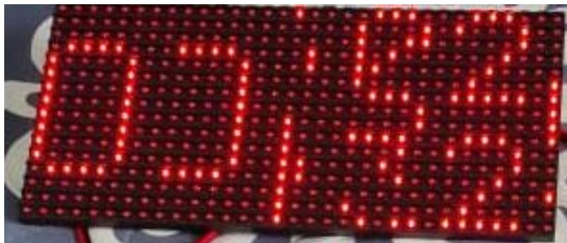
**Figura 79. Pruebas - error en la configuración del RTC.**
